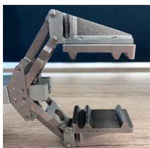
Mors parallèles spéciaux pour lever des sacs Special parallel jaws for lifting bags
